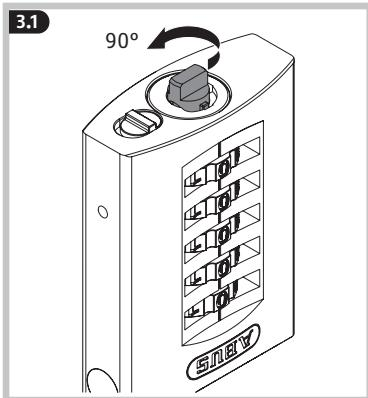
**Option** **(DE)** **Bügel wechseln:** Im geöffneten Zustand den Regler nach rechts schieben und in der Position halten. Stift bis zum Anschlag drehen und Bügel entnehmen. Kugel in die Aussparung des Schlosses legen und neuen Bügel einsetzen.
